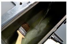
La possibilité d'incliner la cuve à 90° facilite les procédures de nettoyage et de maintenance.
