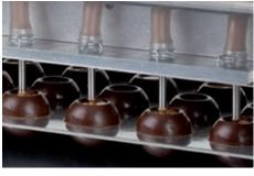
La quantité exacte de produit à doser et la vitesse de remplissage sont parfaitement contrôlées grâce aux réglages de la pression à l'intérieur de la cuve (de 0 à 1 bar) et du temps d'ouverture des buses.
